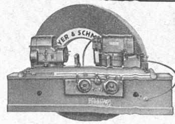
Machines à rectifier à commande hydraulique
