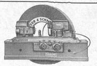
Machines à rectifier à commande hydraulique
