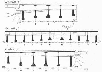
Fig. 4. — Système statique du tronçon 3 (lot 3) ; échelle 1 : 800.
