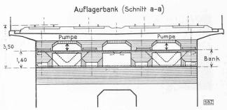
Fig. 16. — Comme fig. 15. Elévation et détails de construction. Auflagerbank = banc d'appui — Pumpe = vérin.
