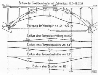
Fig. 8. — Lignes d'inflexion de la grande voûte sous les charges des parties supérieures avec les allongements au sommet, au quart et à la naissance, y compris l'influence du temps en 1939. Mouvements des appuis et influence de la température. Influence du poids des parties supérieures et du temps du 14 février au 14 décembre 1939.
