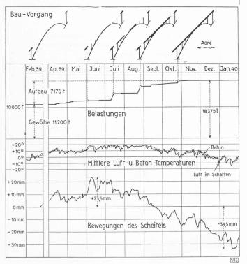
Fig. 7. — Mouvements du sommet de la voûte pendant l'année 1939 provoqués successivement par les charges de la partie supérieure en construction et par les changements de température.
