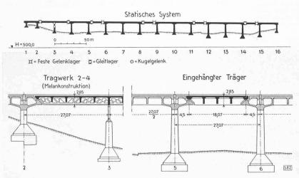
Fig. 3. — Système statique du tronçon 2 (lot 2) ; échelle 1 : 4000. Construction e i béton armé, échelle 1 : 800.
