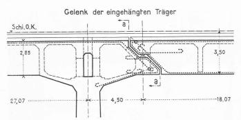
Fig. 15. — Articulation de la poutre indépendante.
