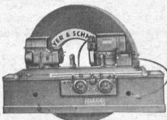
Machines à rectifier à commande hydraulique
