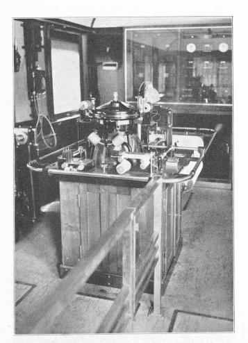
Fig. 30. — Table des appareils avec gyroscope, vue depuis l'arrière. (A l'arrière-plan le tableau portant l'appareillage électrique pour gyroscope et éclairage.)
