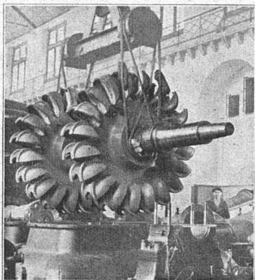
Roue Pelton des Turbines de 15 000 CV Usine Amsteg des CFF
