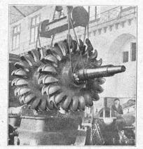
Roue Pelton des Turbines de 15 000 CV Usine Amsteg des CFF
