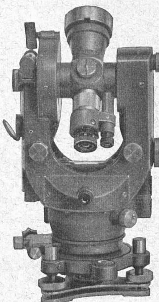
Le changement le plus important dans ce nouveau modèle se réfère à la stabilité de l'instrument qui a été augmentée en remplaçant les paliers de métal léger par des paliers en bronze.
