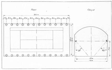
Fig. 5. - Plan et coupe d'un court d'entraînement.
