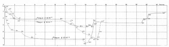
Fig. 2. — Essais sur le grès. Tassements en fonction du temps.
