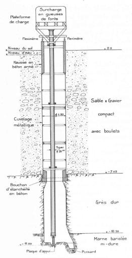
Fig. 1. — Coupe verticale du puits.
