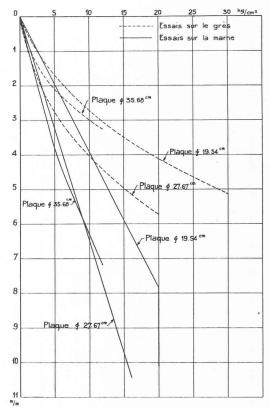
Fig. 4. — Tableau comparatif des tassements en fonction des pressions.
