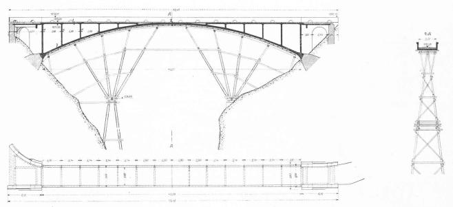
Fig. 3. — Pont de Valtschiel. Portée, 43 m. Epaisseur de la voûte, 23-29 cm. Projet *Maillart.* — Construit, en 1926, par *Hartmann & Cie.* — *Le prototype des ponts à* « arc raidi ».
