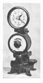
Fig. 3. — Compteur Siemens à disque, à réglage préalable de la quantité de liquide à débiter. Les compteurs de ce genre sont utilisés dans l'industrie chimique quand il s'agit de préparer un mélange d'une composition déterminée. La quantité devant être débitée est fixée d'avance en plaçant le bouton du cadran inférieur à la valeur désirée. Après écoulement de cette quantité, le compteur ferme automatiquement la vanne d'admission.
