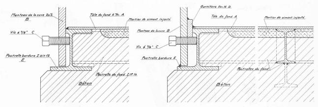
Fig. 6. — Coupe de l'assemblage de la paroi inférieure du manteau avec le fond.
