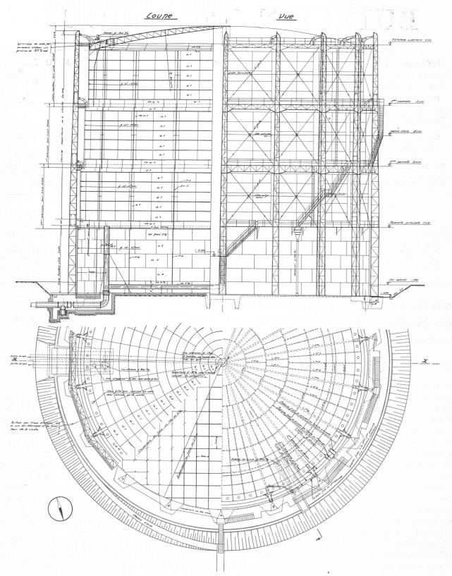
Fig. 1. — Plan d'ensemble du gazomètre de 50 000 m³ — Echelle 1 : 400.
