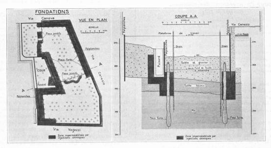
Fig. 1. — Schéma des travaux d'injections chimiques visant à pétrifier et à imperméabiliser des sables, pour permettre l'exécution des fondations d'un immeuble à Lugano.
