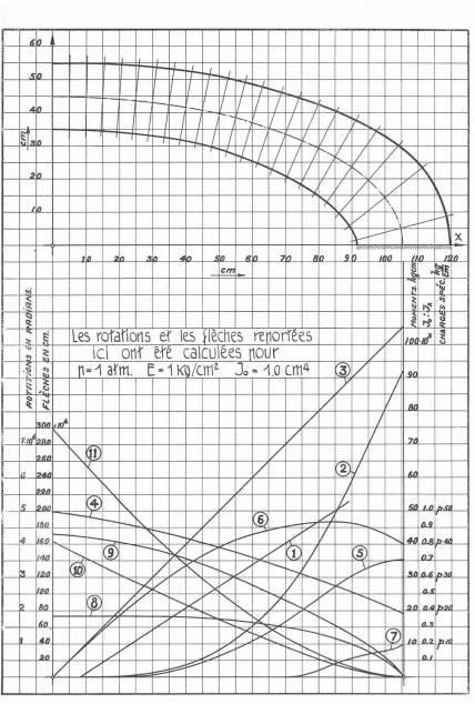
Fig. 10. — Courbes diverses, définissant la ligne élastique de la bride elliptique.
