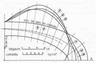
Fig. 11. — Contraintes le long de la face supérieure de la bride elliptique, reportées à partir de cette face.
