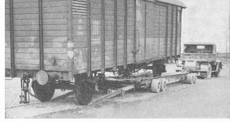
Fig. 3. — Chargement d'un wagon sur le chariot CFF.
