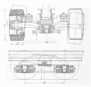
Fig. 6. — Bogie du chariot CFF.
