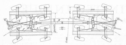
Fig. 1. — Schéma du dispositif de direction du chariot DR.
