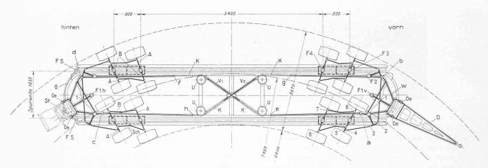
Fig. 7. — Schéma du dispositif de direction du chariot CFF.
