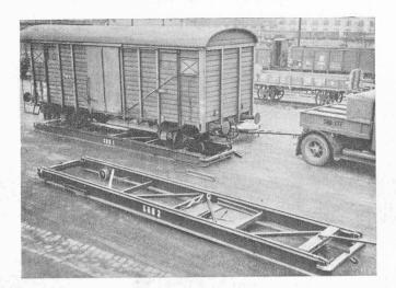
Fig. 11. — Rampe mobile des CFF.
