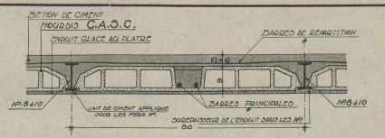
Les hourdis système CASC en béton vibré (Brevetés) vous donnent des planchers creux en béton armé sans coffrage, légers, rapides, résistants, économiques, bons isolants phoniques et thermiques.
