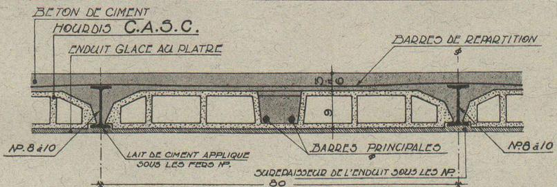
Les hourdis système CASC en béton vibré (Brevetés) vous donnent des planchers creux en béton armé sans coffrage, légers, rapides, résistants, économiques, bons isolants phoniques et thermiques.
