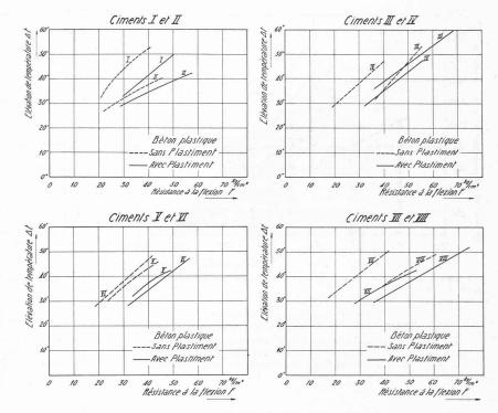
Fig. 7. — Elévation de température en fonction de la résistance déterminée pour des bétons plastiques de différents ciments.
