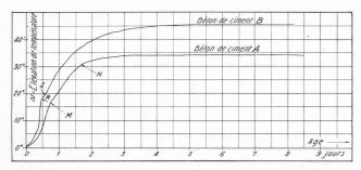
Fig. 3. — Elévation de température relevée sur deux bétons plastiques.
