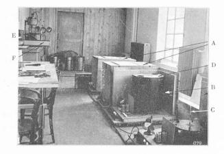
Fig. 1. — Batterie de quatre calorimètres adiabatiques et installations accessoires.
