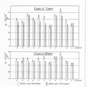
Fig. 6. — Valeurs à 7 et à 28 jours du rapport q/F, de la quantité de chaleur dégagée par kg ciment sur la résistance à la flexion, pour des bétons de différents ciments. Tous les bétons, avec ou sans *Plastiment*, sont gâchés à la même consistance, et gradués suivant
