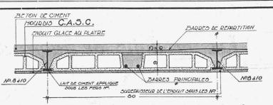
Les hourdis système CASC en béton vibré (Brevetés) vous donnent des planchers creux en béton armé sans coffrage, légers, rapides, résistants, économiques, bons isolants phoniques et thermiques.
