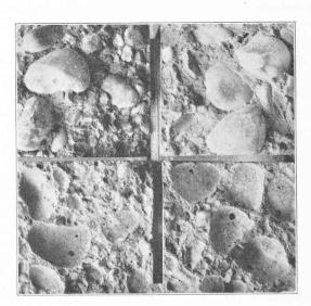
Cassures par flexion suivant un plan horizontal de deux prismes fabriqués en position verticale.
