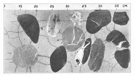
Fig. 6. — Coupe d'un prisme de béton sur laquelle on a fait ressortir la fissuration interne provoquée par les gros graviers lorsque le séchage du béton est trop rapide.
