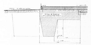
Fig. 10. — Coupe transversale de l'anneau de fondation. Echelle 1 : 80.
