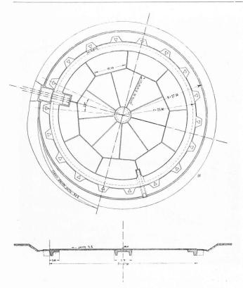
Fig. 9. — Plan et coupe des fondations du gazomètre. Echelle 1 : 800.
