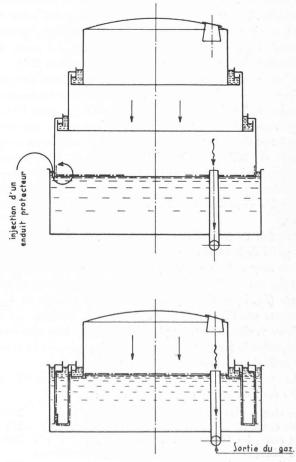
Fig. 3. — Le gazomètre télescopique, pendant sa vidange.
