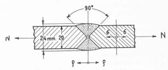
Fig. 8. — Schéma de soudure bout-à-bout.
