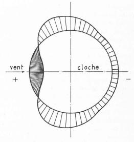
Fig. 5. — Schéma de la répartition de pression et dépression du vent sur un cylindre.
