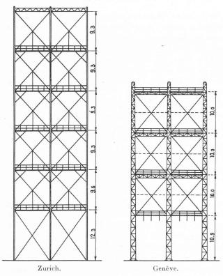
Fig. 6. — Comparaison des charpentes de guidage.
