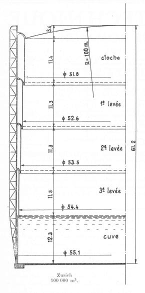
Fig. 1. — Dimensions comparées des gazomètres de Genève et de Zurich.
