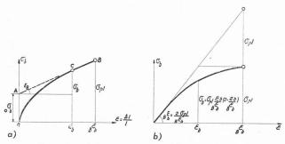
Fig. 5. — a) Diagramme de tension-déformation selon D<sup>r</sup> Friedrich.
