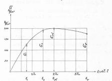
Fig. 2. — Diagramme tension-déformation selon M. Haynal-Konyi,
