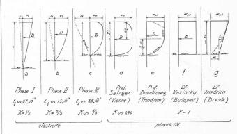
Fig. 4. — Diagrammes des contraintes mis à la base des calculs à la flexion.
