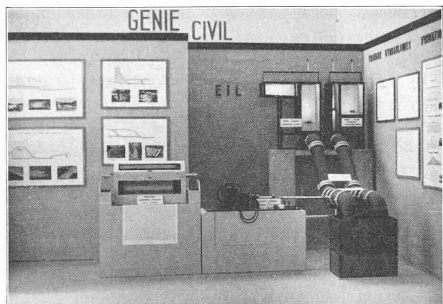
Fig. 3. — Groupe des travaux hydrauliques. Au fond, les deux chambres d'équilibre. Au premier plan, l'appareil de commande des vannes et le chronographe enregistreur.
