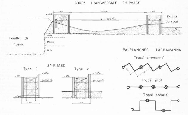
Fig. 13. — Coupes schématiques des batardeaux et types de palplanches.
