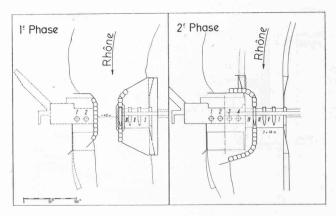
Fig. 12. — Schéma des phases de construction.
