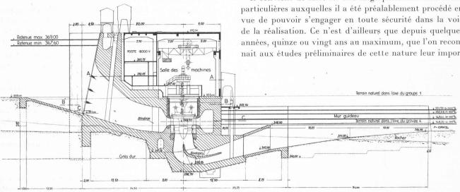
Fig. 4. — Salle des machines. Coupe transversale. — Echelle 1:600.
