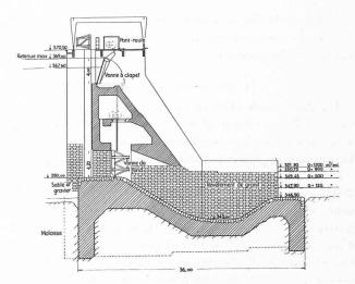
Fig. 3. — Barrage. Coupe transversale dans une ouverture. Echelle 1:600.
