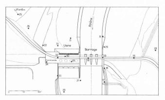
Fig. 5. — Plan de situation des sondages géologiques.
