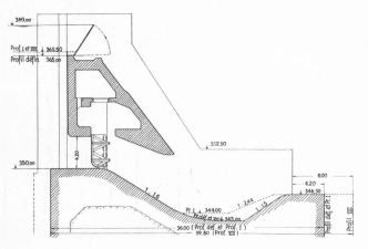
Fig. 9. — Radier du barrage. Profils d'essais.
