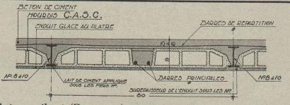
Les hourdis système CASC en béton vileré (Brevetés) vous donnent des planchers creux en béton armé sans coffrage, légers, rapides, résistants, économiques, bons isolants phoniques et thermiques.
