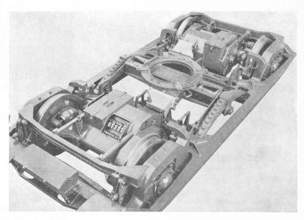
Fig. 5. — Bogie moteur, construit par la Société Industrielle Suisse, Neuhausen.
