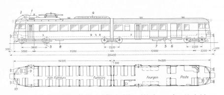
Fig. 3. — Train léger CFZe 2/6 681 du BSB. 1: 250. — 101 places assises, 39 pl. debout. Poids en service 42,8 t, — 1 Transf. à gradins, 2 Contact. méc.-pn. de graduation, 3 Moteur de traction, 4 Résistances de freinage, 5 Moteur-compresseur, 6 Moteur-génératrice, 7 Batterie d'accumulateurs, 8 Shunt pr. mot. de traction, 9 Tableau de distribution, 10 Coupleur-inverseur.
