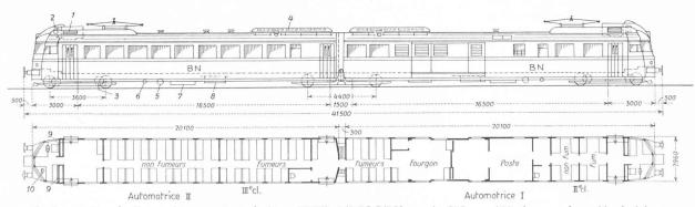
Fig. 2. — Croquis d'encombrement du train léger BCFZe 4/6 BLS/BN. — 1:250. — 139 places assises, 41 pl. debout. Poids en service 68 t. — 1 Transformateur à gradins, 2 Contacteurs méc.-pn. de grad., 3 Moteur de traction, 4 Résistances de freinage, 5 Moteur-compresseur, 6 Moteur-génératrice, 7 Batterie d'accumulateurs, 8 Shunt pr. moteur de traction, 9 Tableau de distribution, 10 Coupleur-inverseur.
