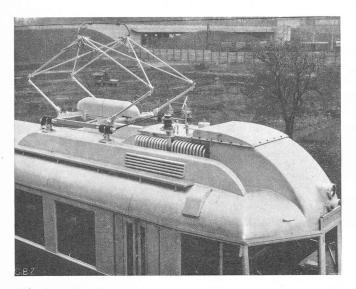
Fig. 4. — Transformateur avec contacteurs de couplage sur le toit.
