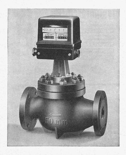
Lecture directe de la consommation de chaleur en kilo-calories. Indication simultanée de la quantité d'eau et de la différence de température. Pas de source de courant auxiliaire. Emploi de compteurs d'eau à accouplement magnétique. Mesure de la différence de température à l'aide de couples thermoélectriques en connexion très simple.
