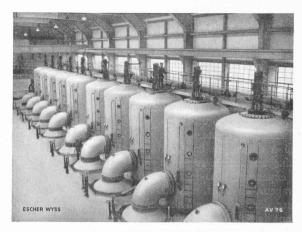
Fig. 9. — Appareils d'évaporation prévus pour évaporer 80 000 kg par heure.
