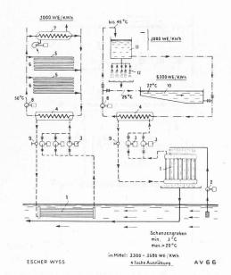
Fig. 16. — Schéma de l'installation de chauffage de la nouvelle piscine de Zurich: 1, évaporateur, 2, pompes d'aspiration de l'eau du fleuve, 3, pompes à chaleur, 4, condenseurs, 5, chauffage par le plafond, 6, circuit de circulation d'eau chaude, 7, chauffage par ventilation, 8, pompe de circulation d'eau chaude, 9, vanne de laminage pour le retour du fluide vaporisateur, 10, piscine, 11, réservoir pour l'eau des douches (chauffée pendant la nuit), 12, douches.
