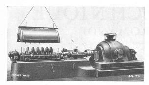
Fig. 10. — Pompe à chaleur pour une installation d'évaporation.
