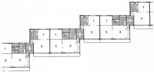
Fig. 13. — Plan de blocs locatifs. — Echelle 1:400.
