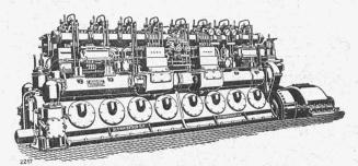
Moteur Diesel marin avec inverseur de marche système "SLM-Winterthur". Compresseurs rotatifs et Pompes à vide
