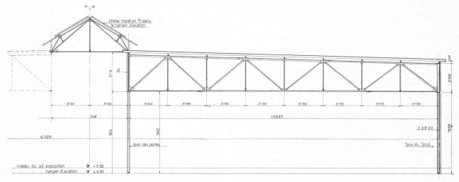
Fig. 2. — Halle « Fers, métaux, machines ». Coupe transversale. On voit ici l'une des deux halles d'aviation et le lanterneau qui la réunit à la seconde qui lui est opposée.
