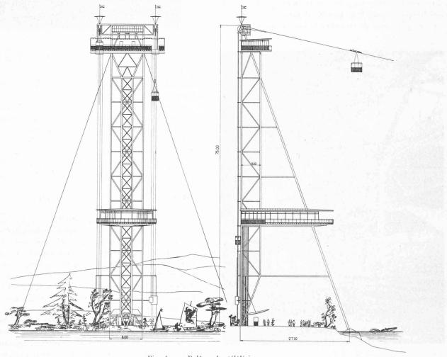
Fig. 4. — Pylône du téléférique. Ce dessin schématique montre la vue de face et la vue latérale du pylône de la rive gauche, avec le restaurant, à 25 m au-dessus du sol. On distingue ici particulièrement bien les 3 éléments constructifs, soit la tour, la contrefiche et les deux haubans. Le pylône de la rive droite ne diffère que par le fait que la plate-forme du restaurant est remplacée par une simple traverse horizontale.
