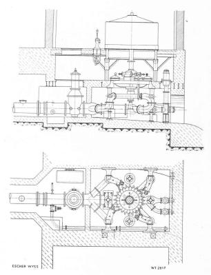
Fig. 1. — Turbine Pelton de 16 000 ch. Exécution de 1908.
