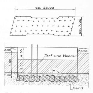
Fig. 2. — Etanchement du fond d'une fouille au moyen d'un voile de « sphères », par le procédé Shellperm.
