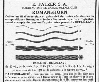
tion normale. Très caractéristique aussi est la formation symétrique en spirales simple des torons et en spirales double du fil seul.
