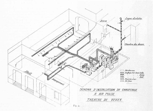
clite construits dans le sous-sol et aboutissant à l'entrée du ventilateur qui le pulse à travers les aérothermes, dans les gaines d'air chaud débouchant dans la salle.
