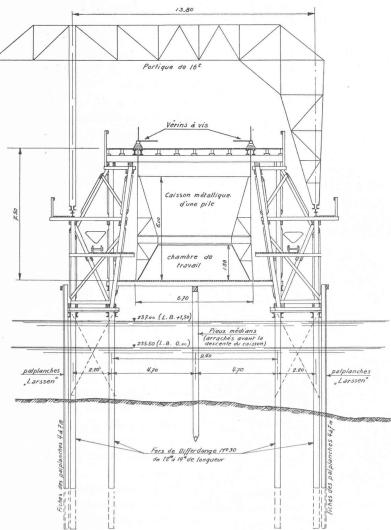
Fig. 13. — Echafaudage des caissons des piles. — Coupe transversale. Echelle 1 : 200.
