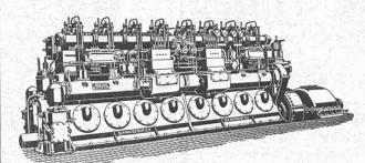
Moteur Diesel marin avec inverseur de marche système "SLM - Winterthur". Compresseurs rotatifs et Pompes à vide
