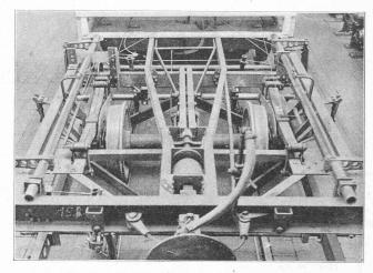
Fig. 2. — Montage de l'appareil de mesure et disposition des câbles sur une voiture à 3 essieux radiants, système Klose.
