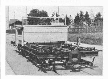
Fig. 3. — Appareil monté sur une voiture à 3 essieux radiants, système Klose, montrant, au premier plan, un palpeur, au milieu, le mécanisme à bielles soutenant le cadre portant les palpeurs et, au fond, l'appareil enregistreur.
