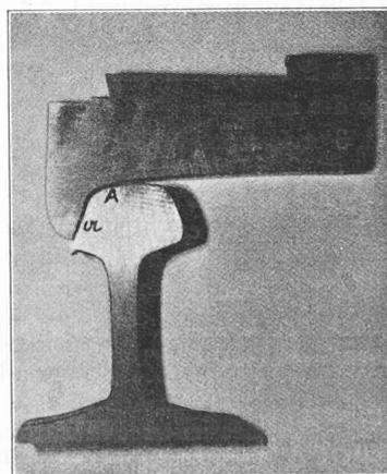
Fig. 1. — Coupe d'un rail et d'un bandage usé.
