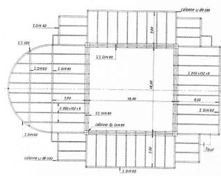
Fig. 3. — Plancher au niveau + 23,50.
