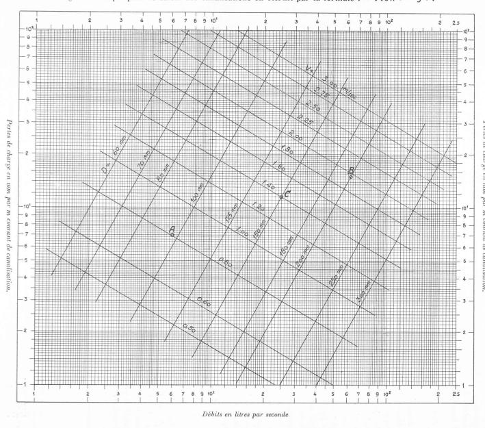
Fig 5. — Abaque pour le calcul des canalisations en éternit par la formule  $\nu=140\,R^{0,645}\,J^{5/9}$ .
