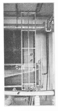
Fig. 2. — Tableau piézométrique. A. Tubes piézométriques; B. Index horizontal pouvant être déplacé le long de la règle graduée centrale et amené en regard des niveaux d'eau; C. Pièces de raccordement des tubes piézométriques aux tubes métalliques; D. Tubes métalliques reliant chaque prise de pression au tableau piézométrique.
