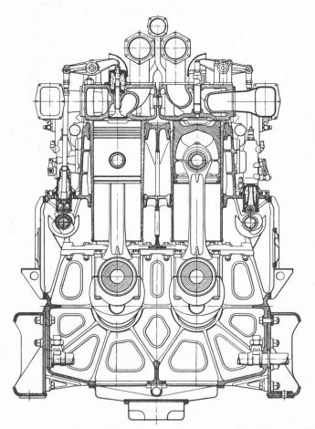
Fig. 4. — Moteur Sulzer-Diesel, de la locomotive de 4400 ch des Chemins de fer roumains (coupe).
