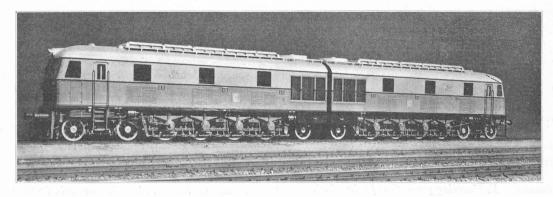
Fig. 3. - Locomotive Sulzer-Diesel, de 4400 ch, des Chemins de fer roumains.
