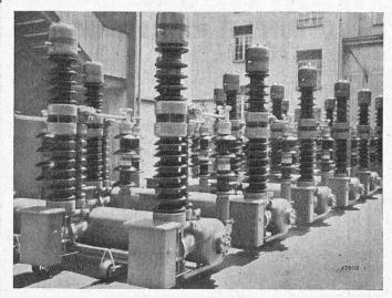
Une série de disjoncteurs pneumatiques ultra-rapides pour montage en plein air, 640 A. Tension nominale 87 kV. Pouvoir de coupure 1000 MVA pour une tension de rétablissement de 75 kV.
