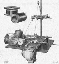
Machine à bobiner automatique pour fils fins, type OOFA.
