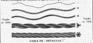
de 20 m/m de  $\Phi$ , seale,  $6 \times 19$  fils  $(9 \times 1,6 + 9 \times 0,9 + 1 \times 1,9$  m/m) en acier clair de 150/160 kg de résistance à la rupture par m/m  $^2$
