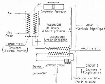
Fig. 1. — Schéma d'une installation de congélation par saumure.
