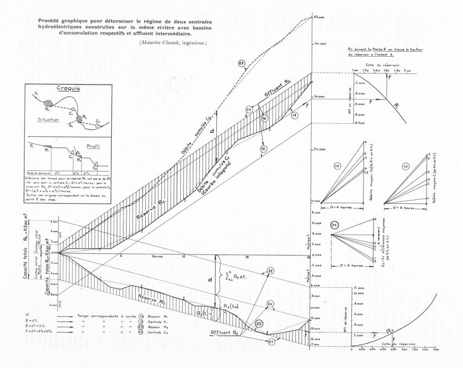
d'exactitude un programme de production pour chaque centrale, en tirant le plus grand profit possible des deux réservoirs. Une certaine inexactitude découle du fait que les rendements et les valeurs  $\Delta T_1, \Delta T_2, \Delta T_3 \ldots$  varient sensiblement avec les débits; mais en admettant des valeurs moyennes appropriées, ces erreurs, qui sont tantôt positives, tantôt négatives, se compensent d'une manière assez satisfaisante, le long du jour.
