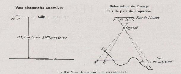
chambres de l'autographe en faisant coïncider les marques des négatifs avec les marques correspondantes des porte-clichés. Le double relèvement est réalisé en trois étapes (Fig. 7 à 9):
