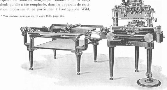
Fig. 7. — Stéréoautographe Wild. — Dernier modèle utilisé par le Service topographique fédéral.
