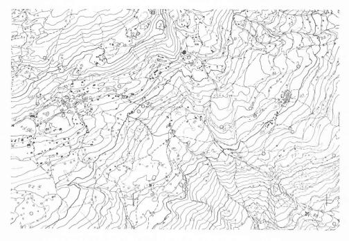
Fig. 12. — Extrait d'une restitution aéophotographie originale. (Echelle 1:25000).
